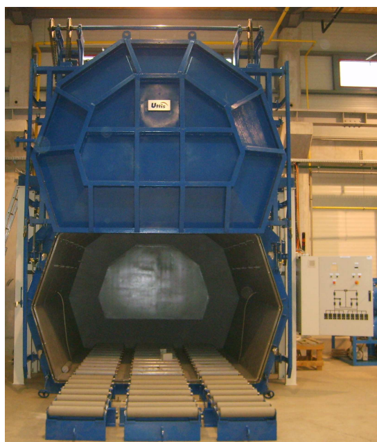
Instalatie pt vidare transformatoare din industria energetica - Romania
